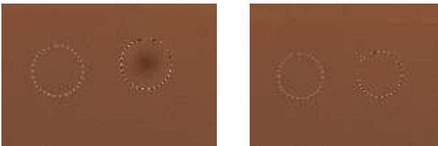
Figur 7. Før reparation til venstre, hvor kloningsområde er angivet. Til højre ses virkning af reparation.
